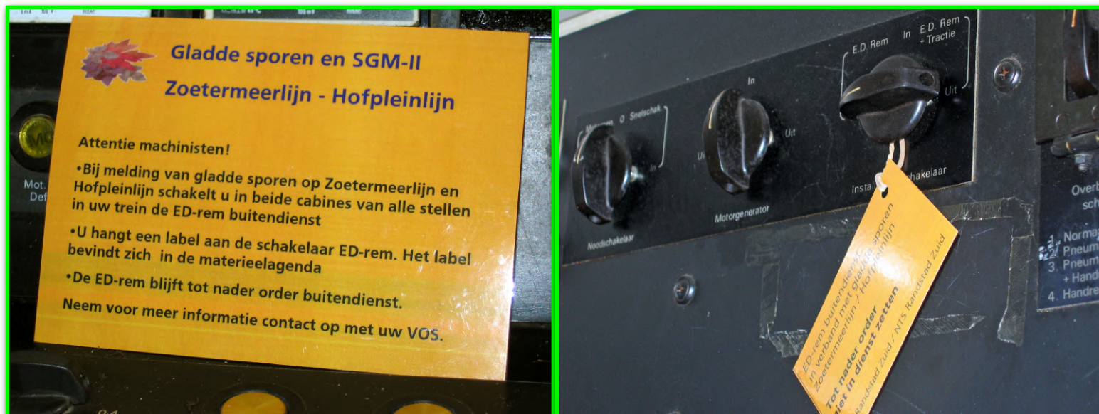
Afbeelding 37. Informatiebordje in de cabine van een Sprinter II treinstel: Bij gladde sporen op de Zoetermeerlijn en de Hofpleinlijn moet de ED-rem (elektronische rem) worden uitgeschakeld. Het label dat aan de schakelaar ED-rem moeten worden gehangen, is te zien op afbeelding 36 392 (Foto C. Cremer, 11-2004).
